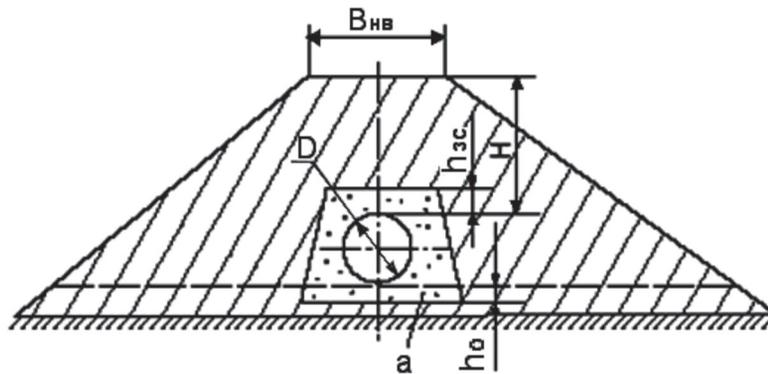
$D$  – наружный диаметр трубы;  $B_{нв}$  – ширина насыпи по верху;
