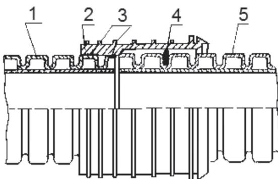
1 – труба с усиленным раструбом (исполнение В); 2 – усиленный раструб; 3 – сварной шов;
