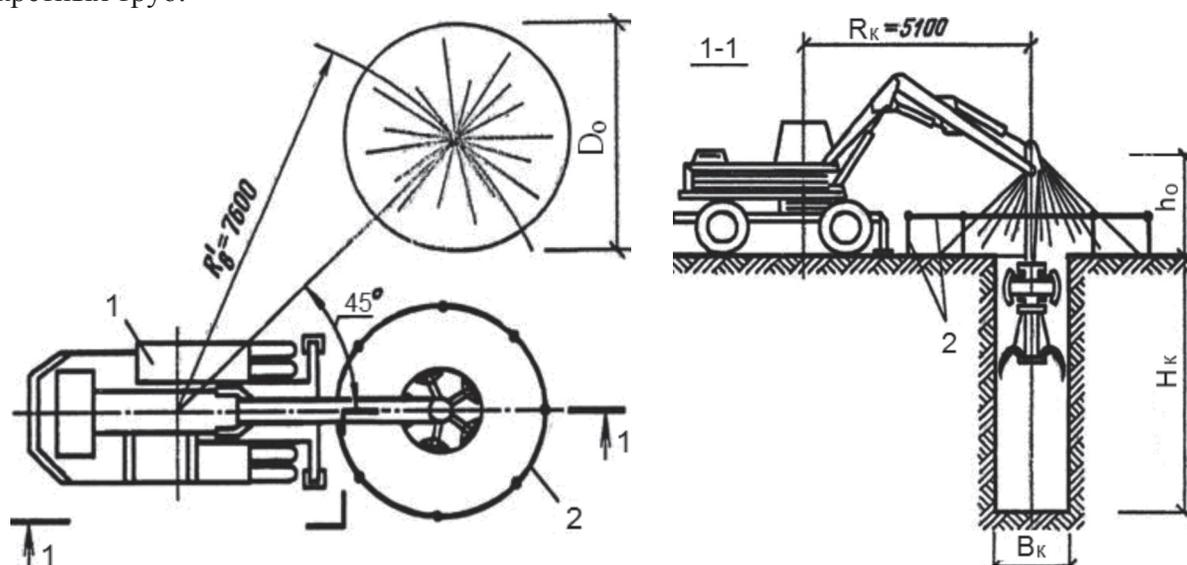
$D_o$ ,  $h_o$  – диаметр и высота отвала грунта;  $B_k$ ,  $H_k$  – ширина и высота котлована;
