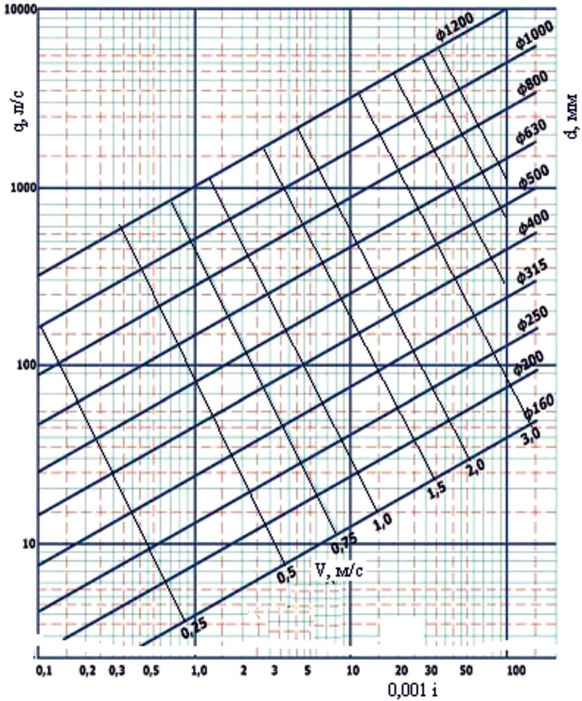
$d$  – диаметр;  $q$  – расход;  $V$  – скорость;  $i$  – гидравлический уклон
