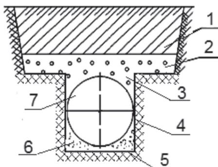
1 – траншея; 2 – защитный слой грунта; 3 – прорезь; 4, 5 – стенка и дно прорези;
