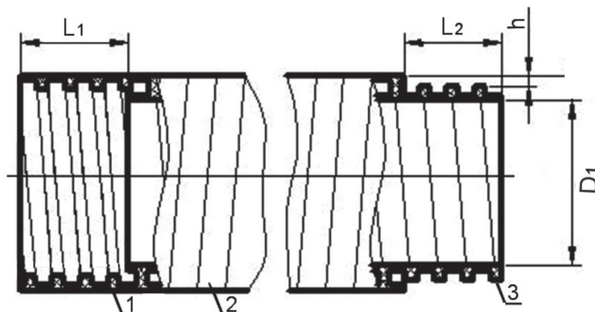
$D_1$  – внутренний диаметр трубы;  $L_1, L_2$  – длины выступов;
