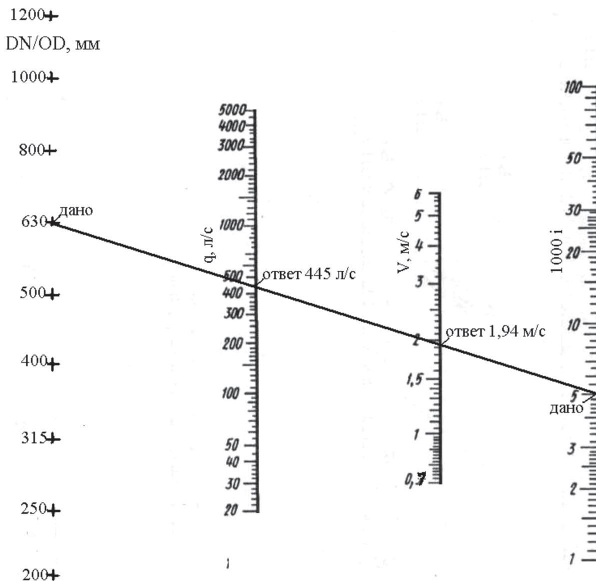
$DN/OD$  – наружный диаметр;  $q$  – расход;  $V$  – скорость;  $i$  – гидравлический уклон
