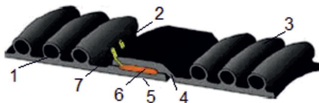
1 – труба с гладким концом; 2, 7 – клеммы; 3 – труба с раструбом;
