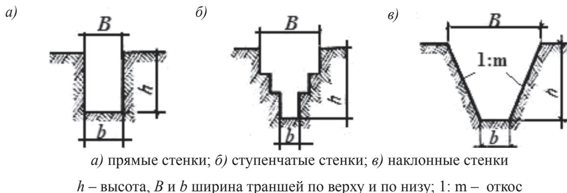
Рисунок 9.47 – Разрабатываемые многоковшовыми экскаваторами траншеи со стенками
