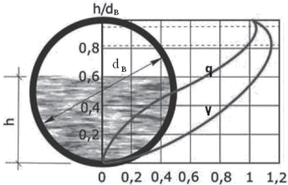
$d_{г}$  – внутренний диаметр труб;  $h$  – заполнение трубопровода;  $q$  – расход;  $V$  – скорость
