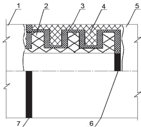
1, 5 – трубы; 2, 4 – внутренний и наружный выступы; 3 – герметик (мастика) между винтовыми выступами; 6, 7 – герметик (мастика) выдавленный внутрь и наружу
