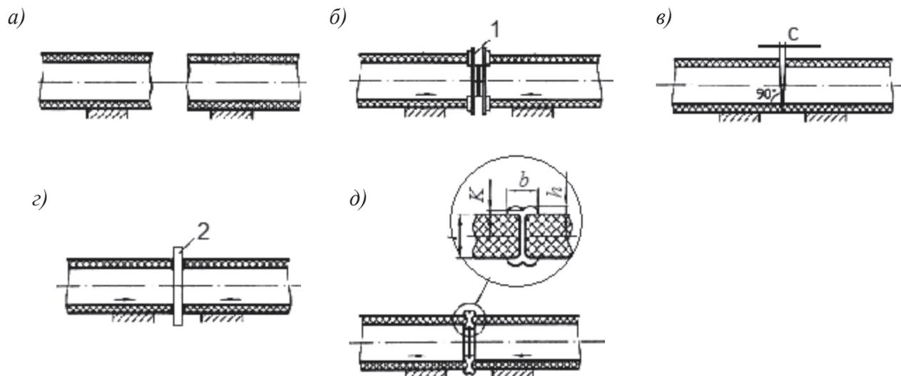
а) центровка и закрепление труб в зажимах сварочной машины;
