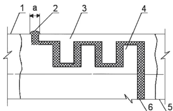
а – зазор; 1, 5 – трубы с внутренними и наружным и выступами; 2, 6 – наружный и внутренний зазоры для подачи герметика (мастики) в пустоты между выступами; 3, 4 – внутренний и наружный выступы
