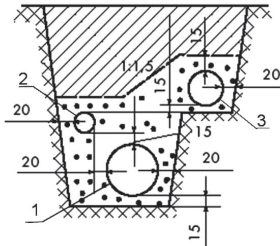
1 – нижний трубопровод диаметром 50 см;
