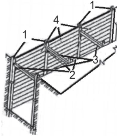
1 – двутавровые балки; 2 – поддерживающие стальные уголки; 3 – деревянные распорки;
