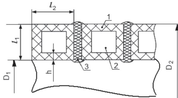
1 – профиль; 2 – полость в профиле; 3 – сварной шов
