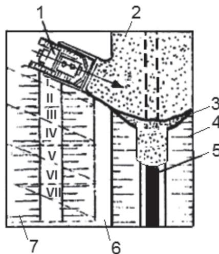
1 – бульдозер; 2 – засыпанная траншея; 3 – засыпка над трубами высотой 0,7 м;
