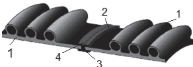
1 – трубы из полого профиля с фигурным поперечным сечением с гладкими концами;
