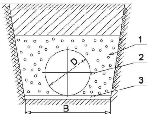
1 – траншея; 2 – труба; 3 – дно траншеи; D – наружный диаметр трубы;
