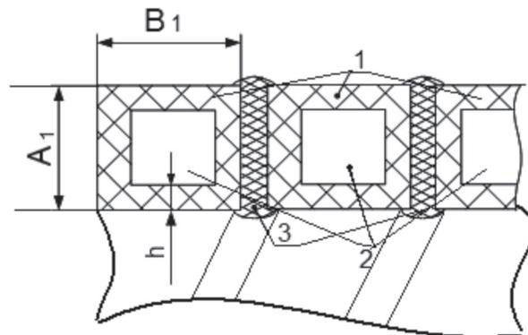
$A_1$  – высота профиля;  $B_1$  – ширина профиля;  $h$  – толщина стенки профиля;
