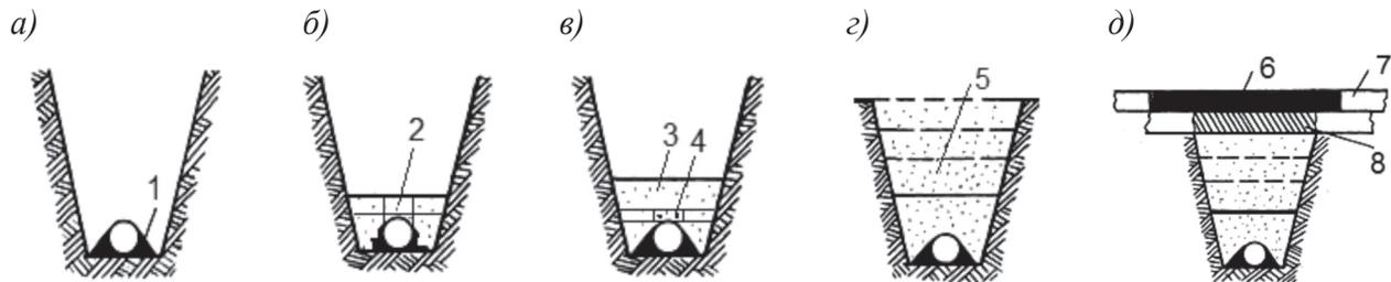
а) подбивка грунта под трубу штопками; б) засыпка и уплотнение песка в пазухах электротрамбовками и в защитной зоне на 30 см выше труб вручную; в) засыпка и уплотнение песка на 75 см выше труб ручными инструментами-электротрамбовками (виброплитами массой до 50 кг); г) засыпка песка верхней зоны траншеи и уплотнение виброплитами массой до 100 кг; д) восстановление дорожного покрытия дороги
