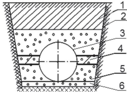
1 – траншея; 2 – стенка траншеи; 3 – трубопровод; 4 – «жесткий слой»;
