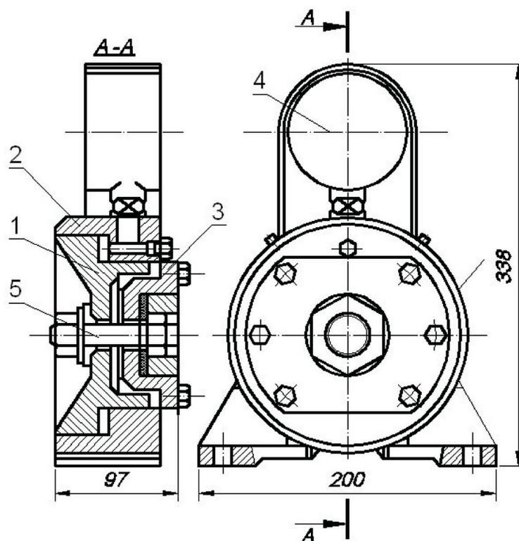
1 – поршень; 2 – корпус; 3 – фланец; 4 – манометр; 5 – испытываемый болт
