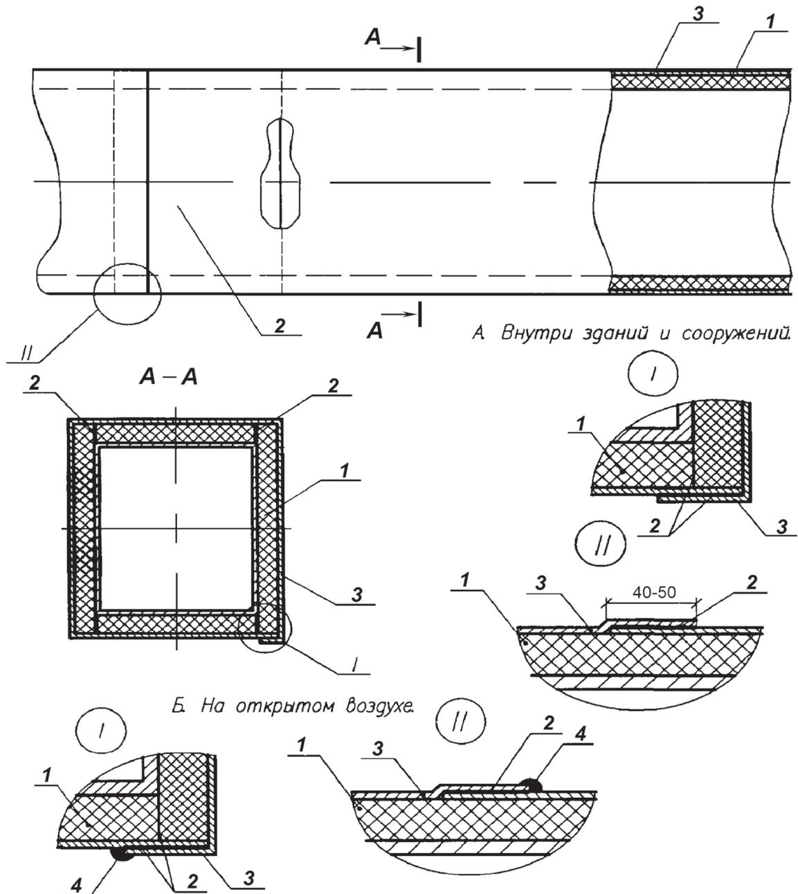
1 – лист самоклеящегося теплоизоляционного материала; 2 – клей;
