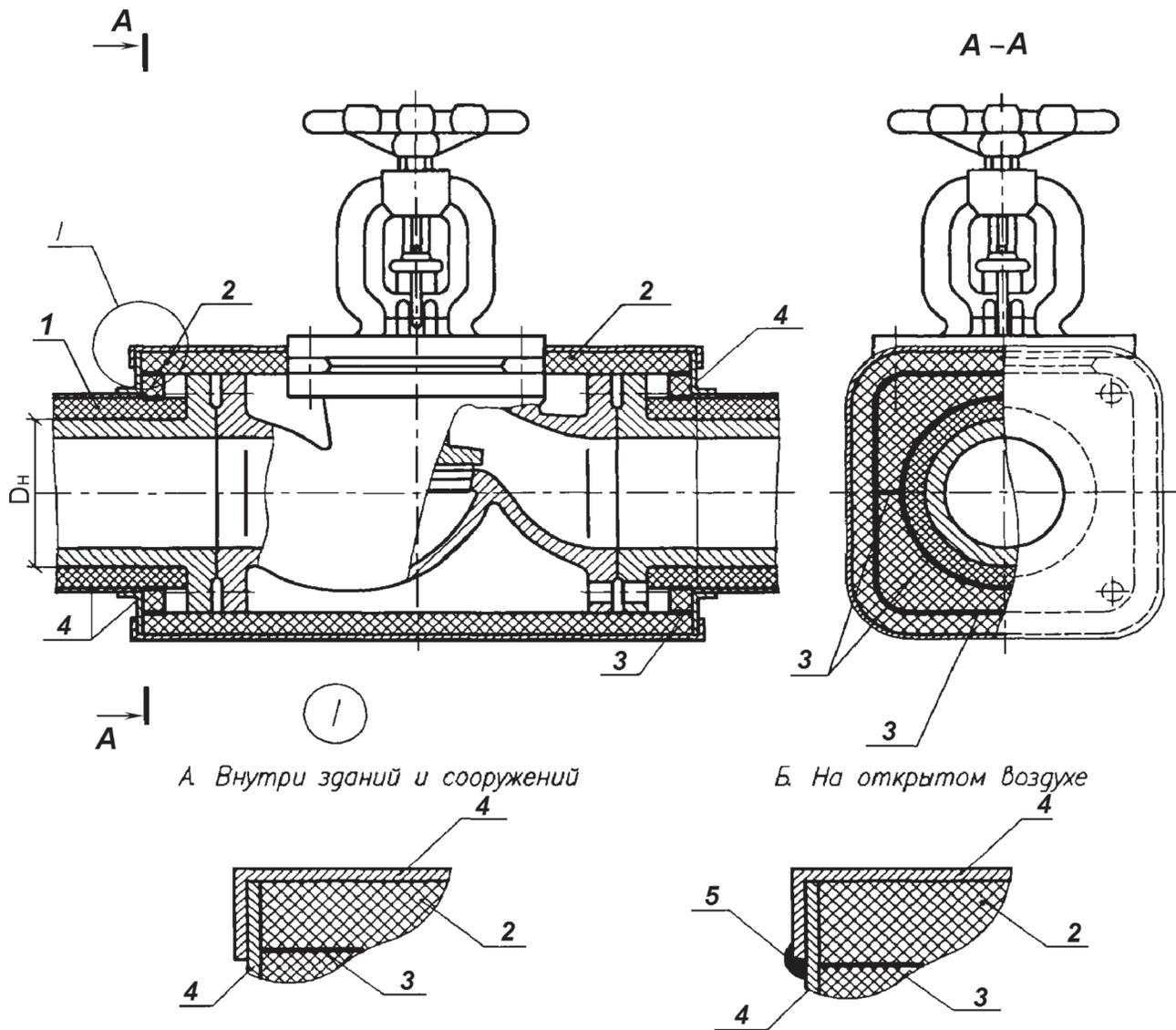
1 – трубка из теплоизоляционного материала; 2 – лист теплоизоляционного материала 3 – клей;
