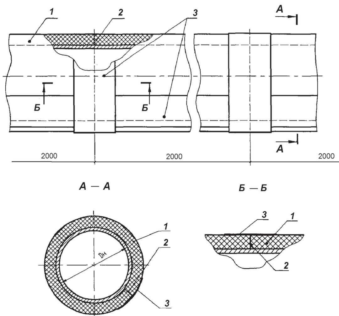
1 – трубка из теплоизоляционного материала; 2 – клей;
