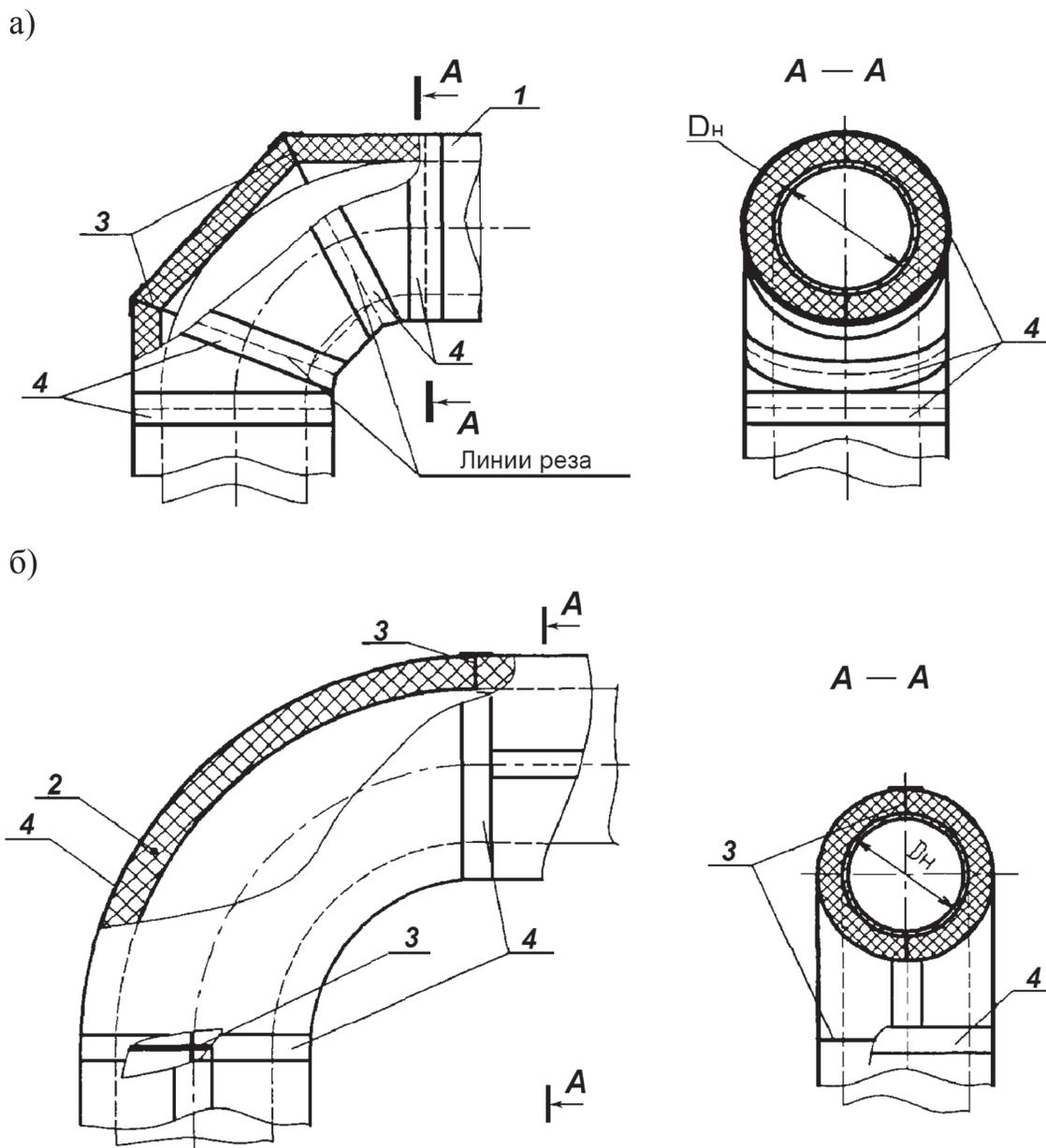
а) изоляция отвода термоизоляционными трубками ( $D_n \leq 160$  мм);
