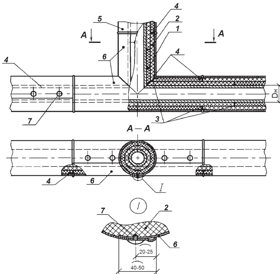
*1* – трубка из теплоизоляционного материала; *2* – лист теплоизоляционного материала;
