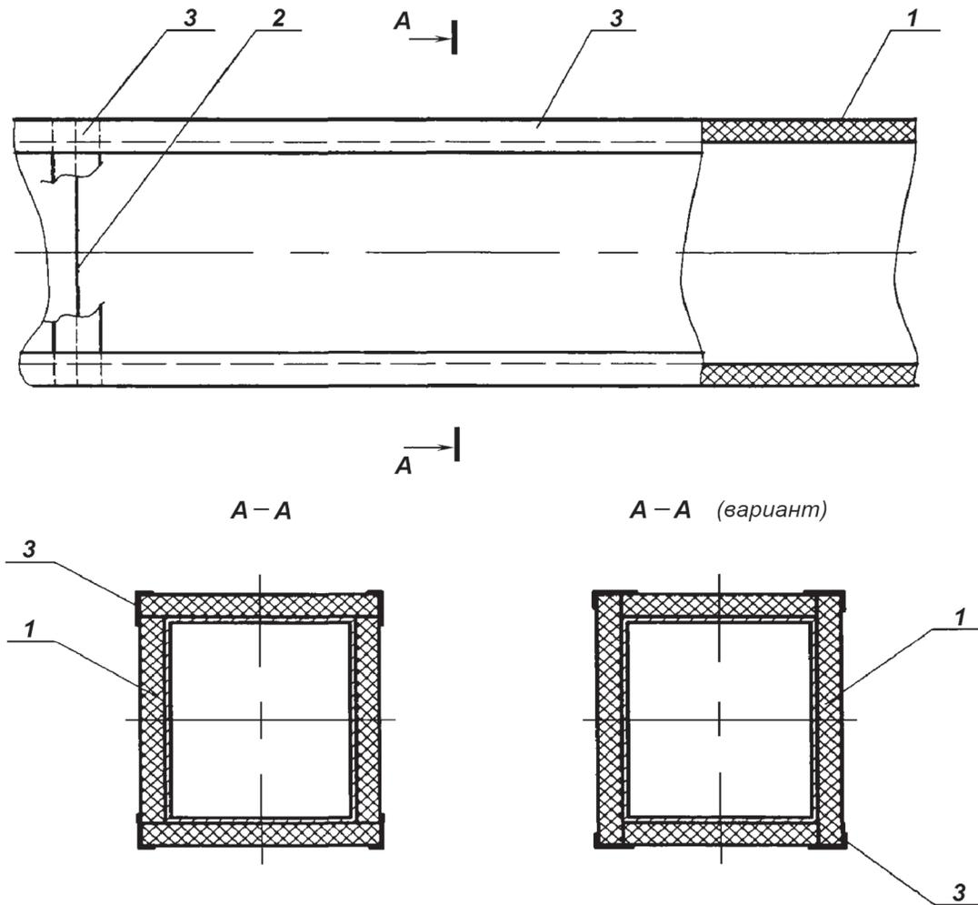
1 – лист самоклеящегося теплоизоляционного материала; 2 – клей;
