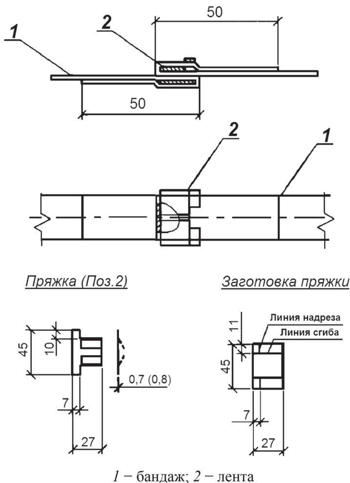
Рисунок 6.2 – Конструкция бандажа
