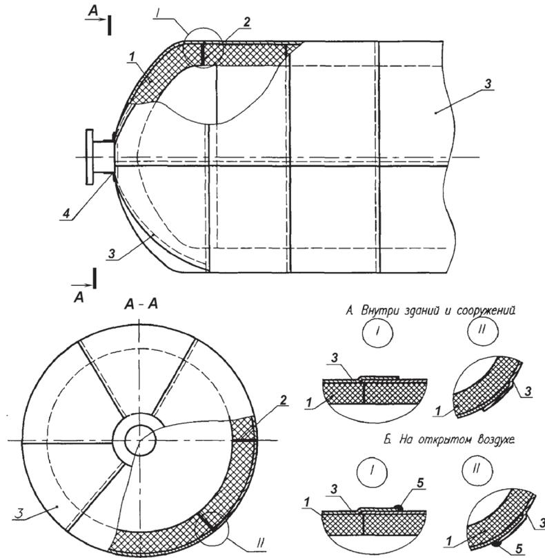
1 – лист из теплоизоляционного материала; 2 – клей; 3 – металлическая оболочка;
