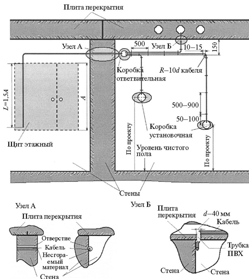
Рисунок 5.3 – Схема расположения скрытых электропроводок
