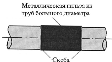
Рисунок 5.43 – Соединение стальных труб с помощью гильз
