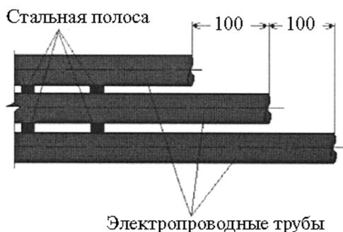
Рисунок 5.41 – Размещение электропроводных труб в блоке соединяемых труб
