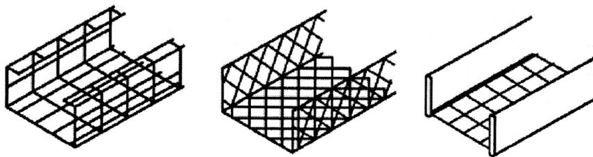
Рисунок 5.13 – Секции сетчатых кабельных лотков
