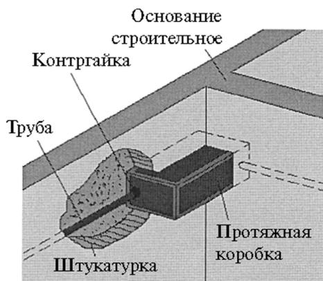
Рисунок 5.40 – Переход труб с одной стены на другую
