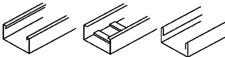
Рисунок 5.11 – Секции кабельных лотков со сплошным дном
