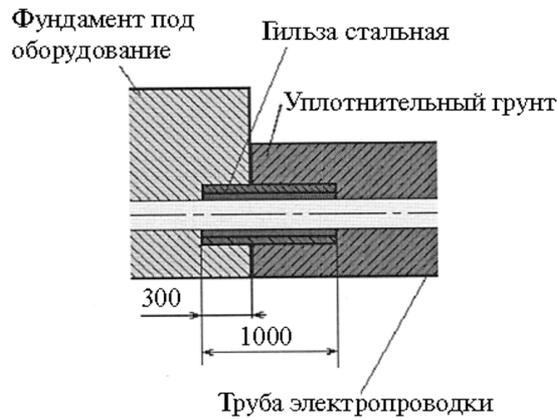
Рисунок 5.38 – Защита трубы при выходе из фундамента в грунт
