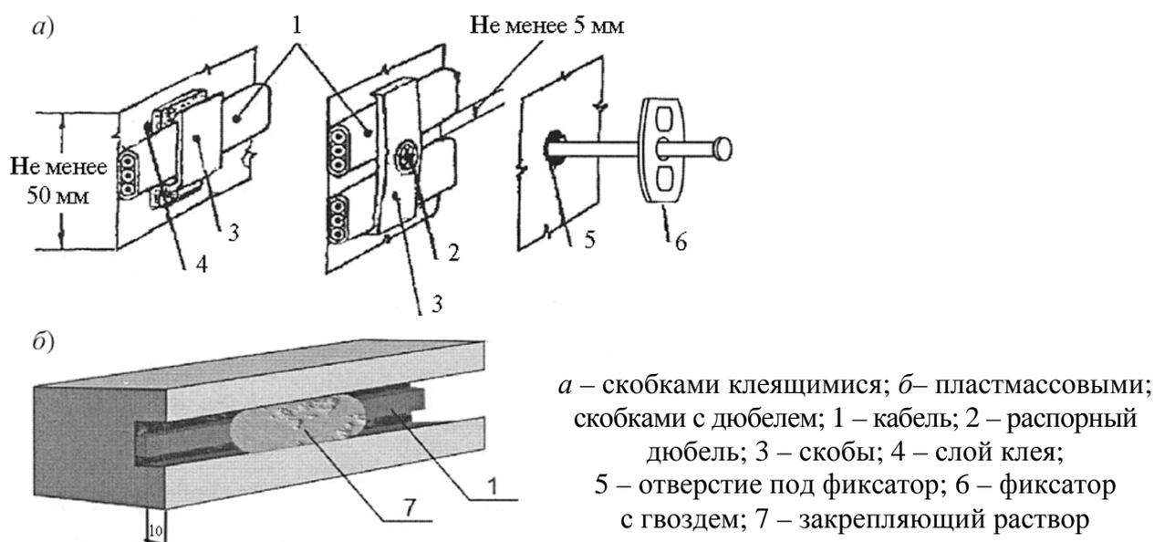
Рисунок 5.4 – Способы крепления кабеля к строительному основанию
