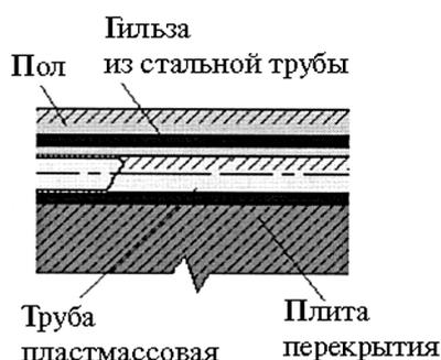
Рисунок 5.52 – Защита пластмассовой трубы гильзой из стальной трубы
