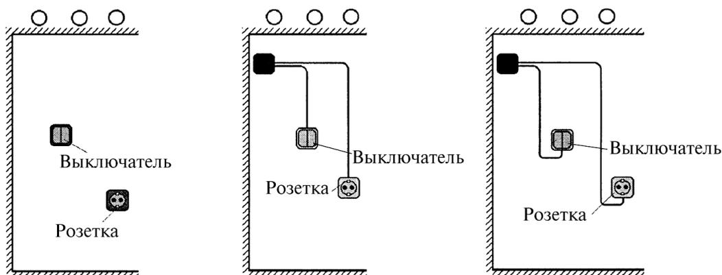
Рисунок 5.53 – Варианты установки розеток и выключателей
