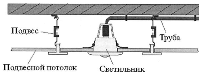
Рисунок 5.55 – Крепление точечного светильника в подвесном потолке
