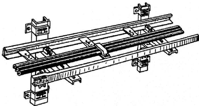
Рисунок 5.18 – Установка кабельных конструкций
