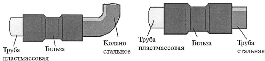
Рисунок 5.49 – Соединение пластмассовых труб при скрытой прокладке
