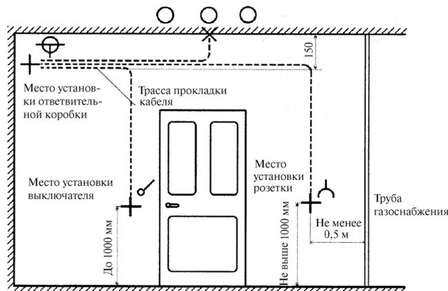
Рисунок В.3 – Минимальное расстояние от выключателей, штепсельных розеток и элементов электроустановок до газопроводов (должно быть не менее 0,5 м)
