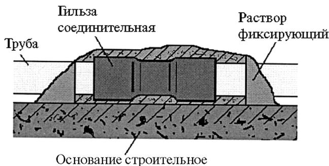
Рисунок 5.50 – Фиксация пластмассовых труб из полиэтилена раствором
