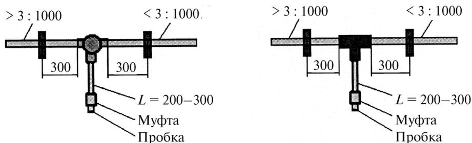
Рисунок 5.35 – Установка водосборных трубок
