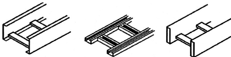
Рисунок 5.14 – Секции кабельных лестниц
