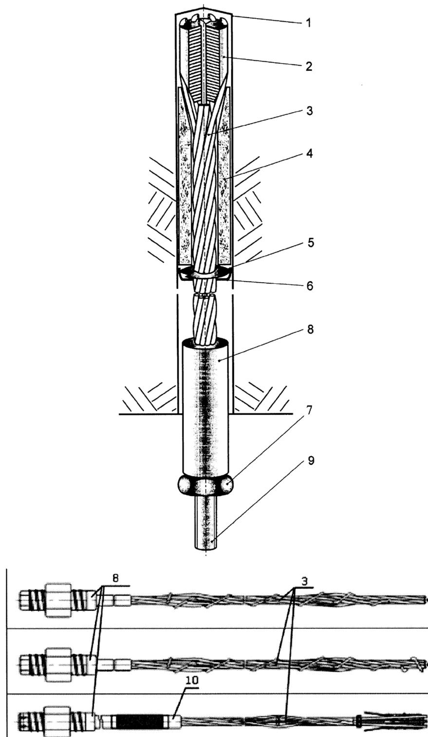
1 – скважина; 2 – опорная головка; 3 – канат; 4 – втулка; 5 – подпорный элемент;
