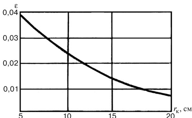
Рисунок Д.1 – Зависимость коэффициента от толщины забутовки  $r_k$
