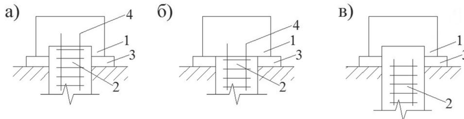
1 – фундамент; 2 – оголовок сваи; 3 – бетонная подготовка; 4 – выпуски арматуры
