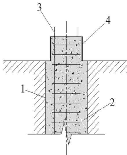
1 – раскатанная скважина; 2 – свежеуложенная бетонная смесь;
