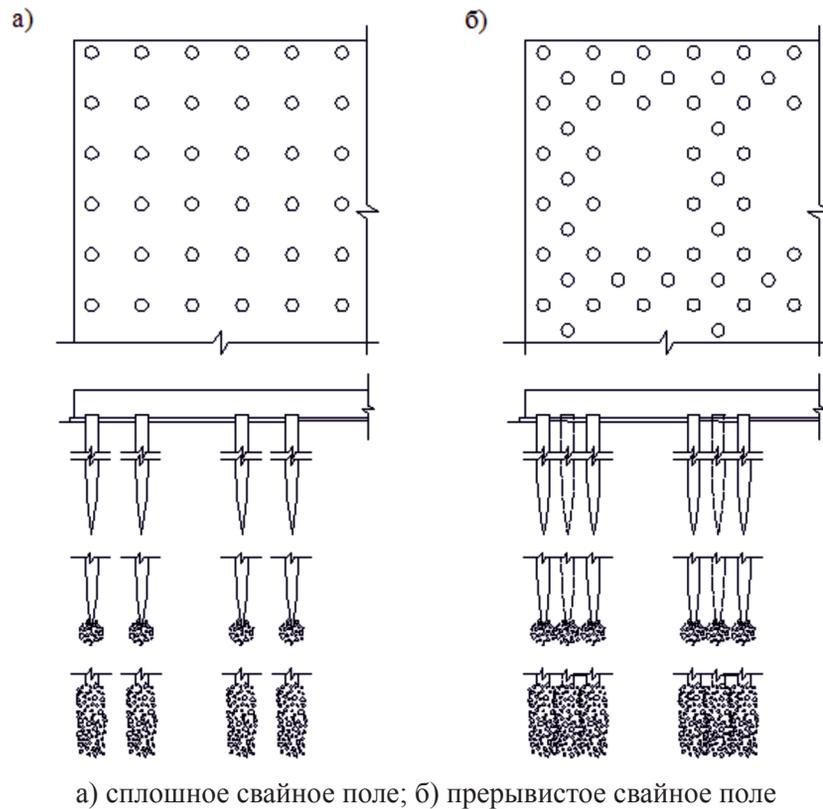
Рисунок 5 – Конструктивные схемы монолитных плитных фундаментов из НРСн
