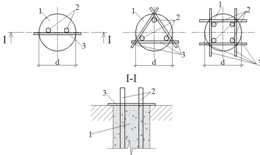
1 – заполненная бетонной смесью скважина; 2 – арматурные стержни; 3 – фиксатор
