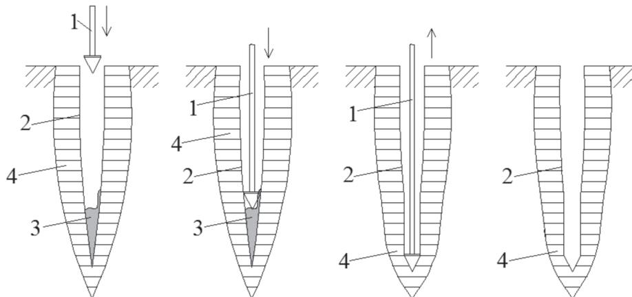
1 – конический штамп; 2 – скважина; 3 – засыпка скважины; 4 – уплотненная зона
