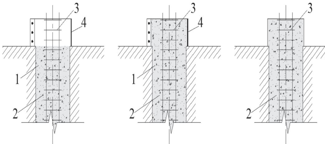
1 – раскатанная скважина; 2 – свежеуложенная бетонная смесь;
