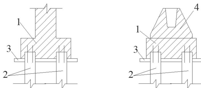
1 – монолитный бетон с армированием; 2 – НРСн; 3 – бетонная подготовка;
