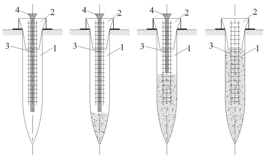
1 – скважина; 2 – бетонолитная воронка; 3 – арматурный каркас; 4 – бетонолитная труба
