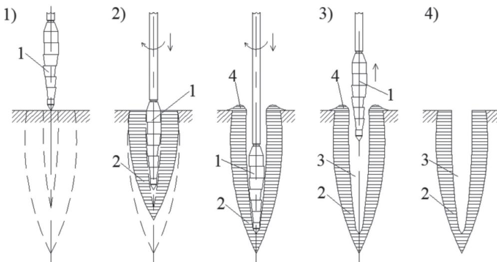
1 – раскатчик; 2 – уплотненная зона; 3 – раскатанная скважина; 4 – выпор грунта
