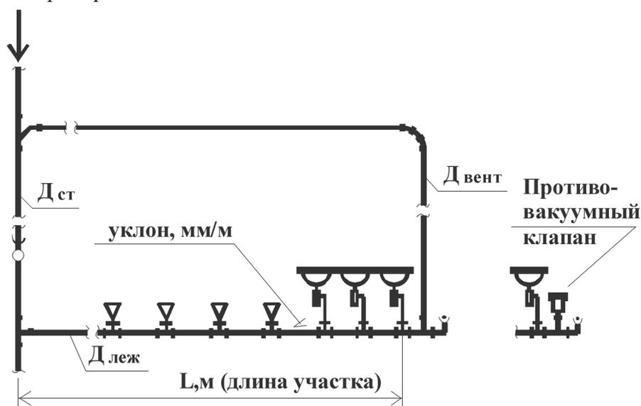
Рисунок 2 – Схема устройства длинной горизонтальной разводки
